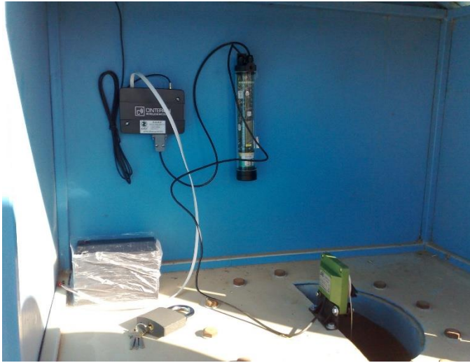
ابزار اندازه گیری سطح آب رودخانه به روش شفت انکودر
