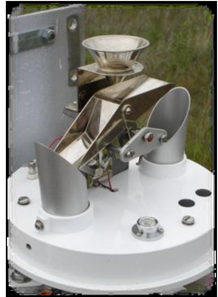
ابزار اندازه گیری باران سنج الکترونیکی (فن آوری TIPPING BUCKET)
