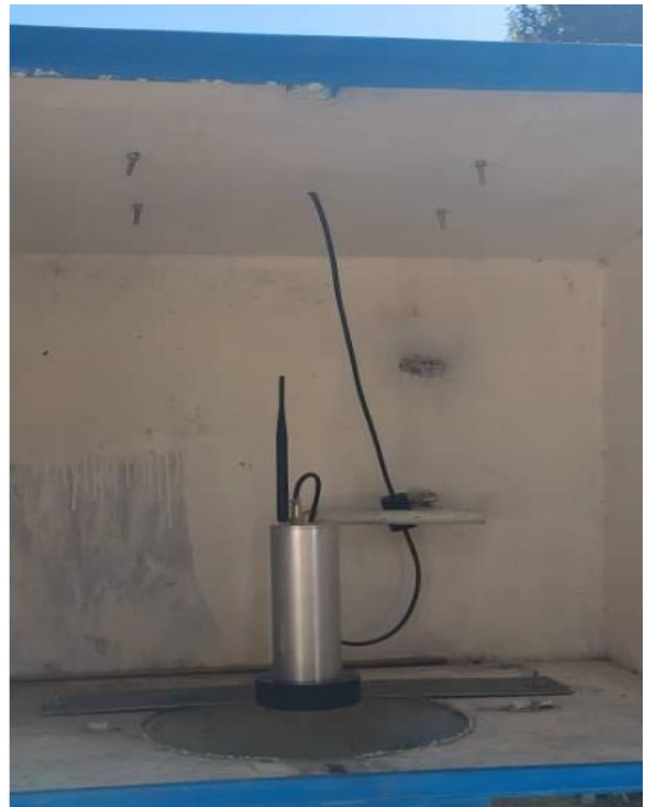
ابزار غیر تماسی اندازه گیری سطح سنج رودخانه (نوع لیزری)
