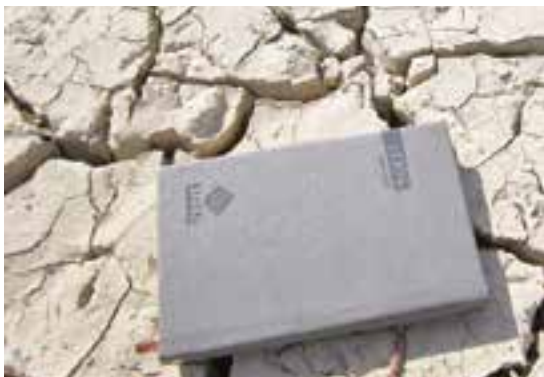
پوشش رسی در حوضچه تزریق مصنوعی که ستبرای آن دست کم ۶۰ سانتیمتر است که نفوذ آب به پایین (آبرفت) ناشدنی شده است.
